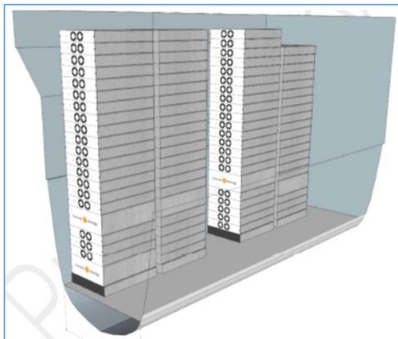
Figure 6, Eksempel på kompakt installasjon i katamaranskrog
